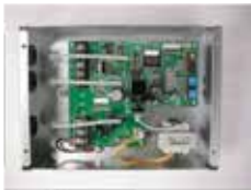
BMS-IFLSV4E TCS net relay interfész // SZÜKSÉGES kiegészítő: érintőképernyős vezérlő
